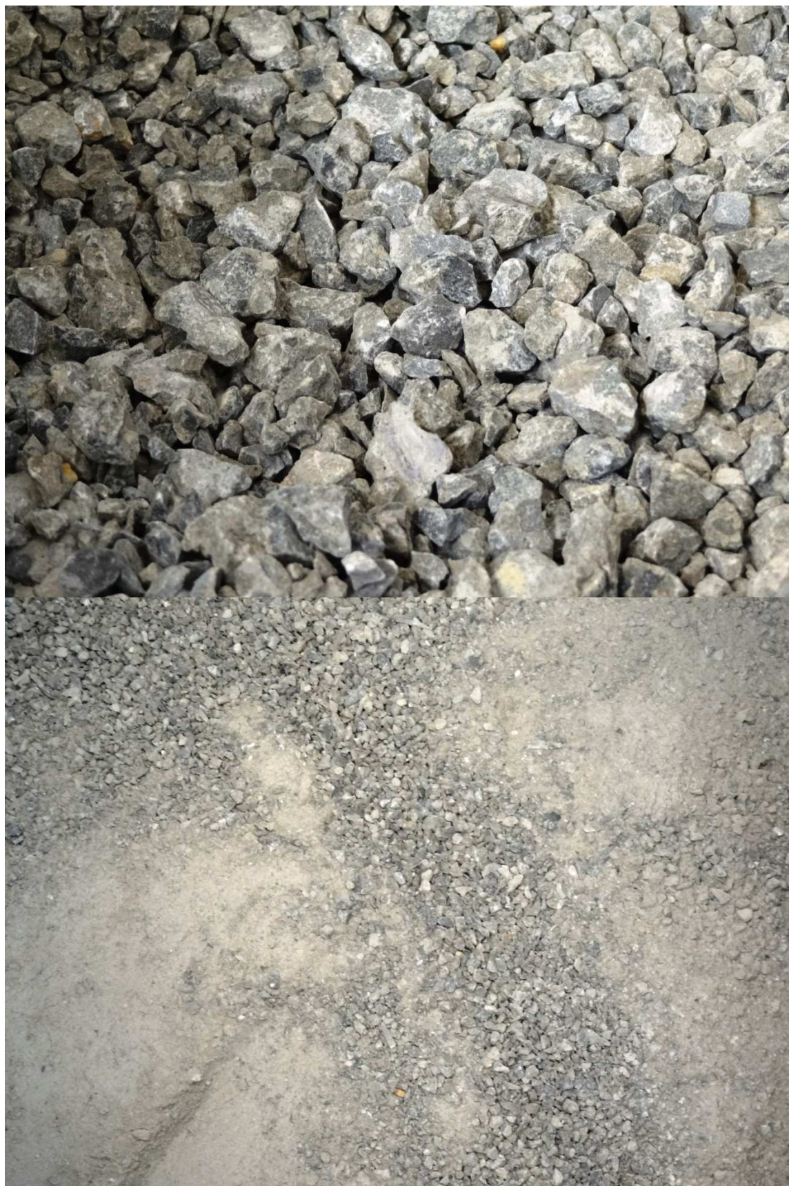
Photographies : Haut : granulat >4\text{mm} / Bas : pâte de ciment <4\text{mm}
