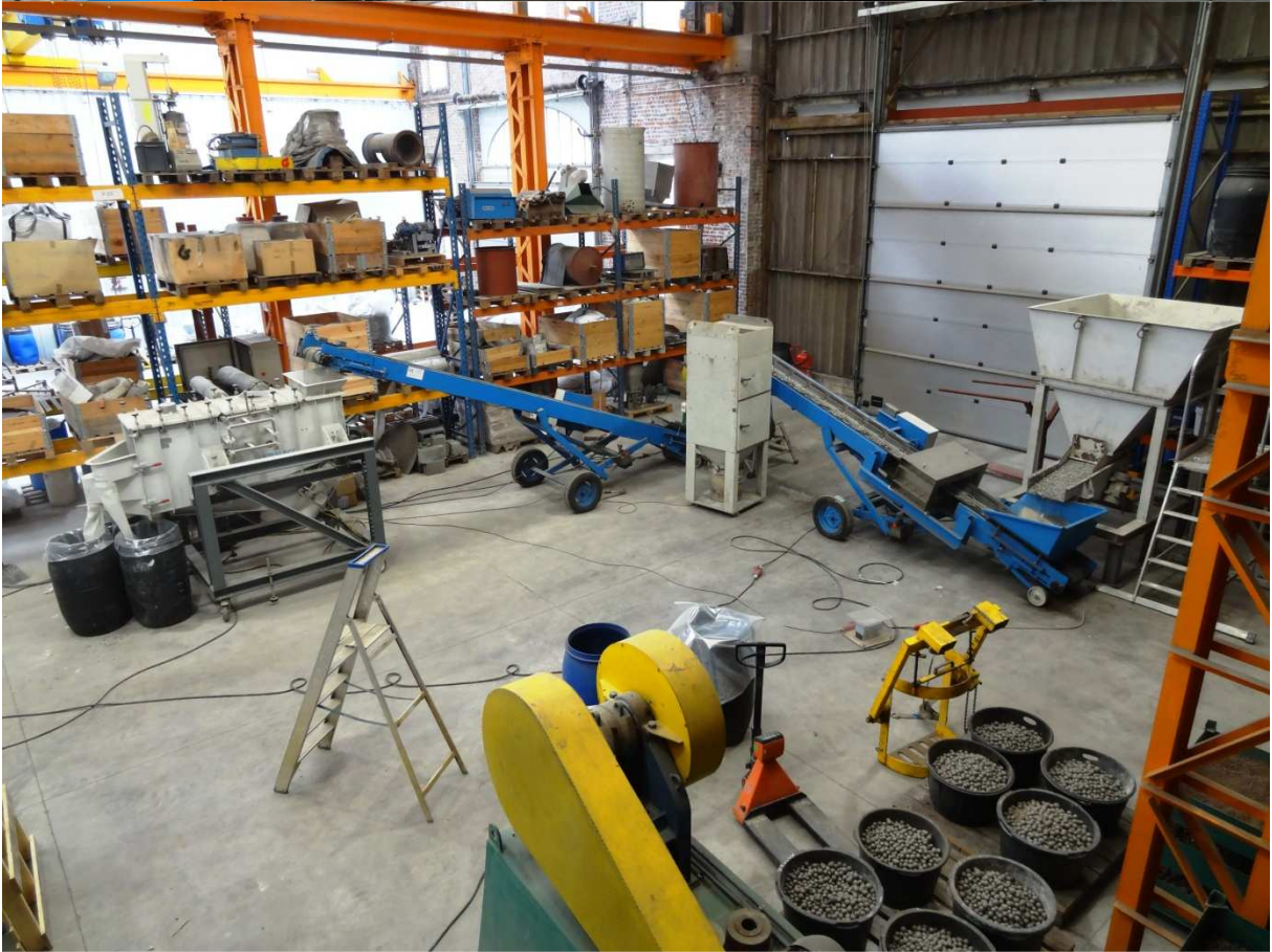
Photographies haut : concasseur à mâchoire (étape 1) ; bas : ligne de traitement (étape 2)
