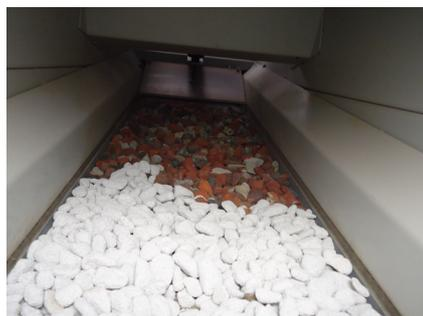
L'objectif est de leur montrer quelques exemples de traitement applicables aux déchets de démolition et déconstruction, voire adaptables pour un traitement sur site. La démonstration d'une séparation plâtre-papier/carton et séparation densimétrique de granulats béton-brique-béton cellulaire est au programme.
